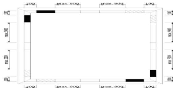
■ - nosná podložka, ▨ - dištančná podložka, ▨ - dištančná podložka dodatočná
