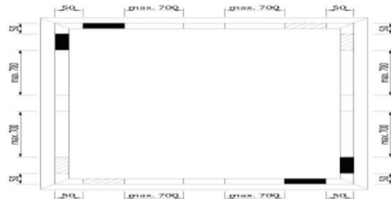
Obr.4 Zásady pre vypodloženie skla (AL)
